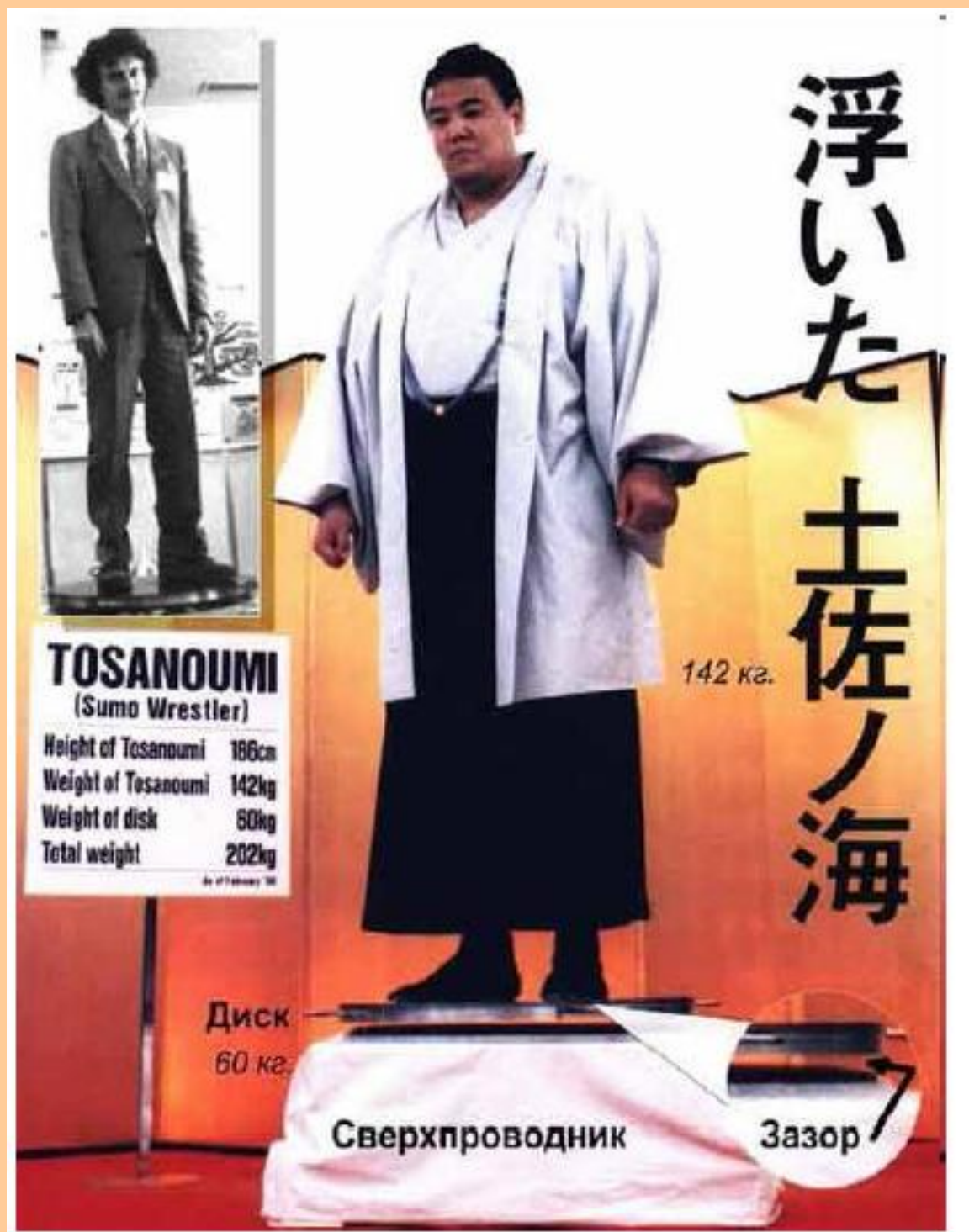
Рисунок 18 – В 1996 г в Токио в Международном центре сверхпроводимости была впервые продемонстрирована магнитная левитация человека. На диске с постоянными самарий-кобальтовыми магнитами стоял 142-кг борец сумо. Диск парил над таблетками ВТСП-керамики YBa_2Cu_3O_z , охлаждаемыми жидким азотом. Вес самого диска 60 кг. Общий вес диска и сумоиста Тосаноуми равнялся 202 кг. Зазор составлял 1 см. Слева вверху – сотрудник лаборатории неорганических материалов Химфака МГУ Гудилин Е. А., ныне член-корреспондент РАН
