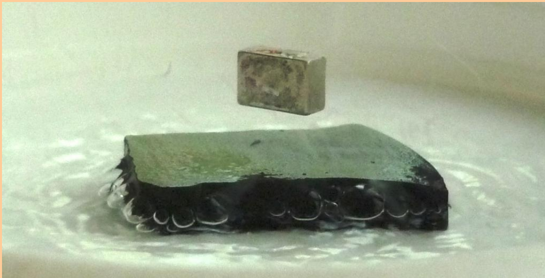
Рисунок 17 – Левитация магнита над ВТСП-керамикой
